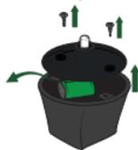
Para substituir a bateria (3) retire os parafusos do compartimento que se encontra na cabeça da luminária e remova a bateria. Faça a substituição por uma bateria recarregável com as mesmas especificações (2/3 AA Ni-Mh 1,2V 150mAh).
