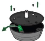
Para substituir a bateria (3) retire os parafusos do compartimento que se encontra na cabeça da luminária e remova a bateria. Faça a substituição por uma bateria recarregável com as mesmas especificações (Lítio 3,2V 250mAh).
