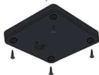
Para substituir a bateria do produto remova os parafusos da parte inferior do painel solar (1). Faça a substituição por uma bateria recarregável com as mesmas especificações (AA Ni-MH, 1,2V 600mAh).
